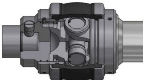
**Tenuta ad albero:** È possibile installare diversi sistemi di tenuta, ogni soluzione è adatta ad impieghi specifici. Le tipologie disponibili sono: tenuta meccanica singola interna, tenuta meccanica singola con quench, tenuta meccanica doppia contrapposta, tenuta meccanica doppia in tandem oltre a baderna e baderna flussata.
